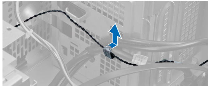
5. לחץ בעדינות על הלשוניות שבשני הצדדים כדי לשחרר ולהסיר את החיישן התרמי מהמארז.
